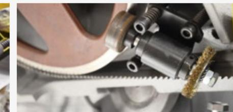
Die Spänebürste ist immer synchron mit der Sägebandgeschwindigkeit angetrieben, so dass ideale Reinigungsleistung garantiert ist.
