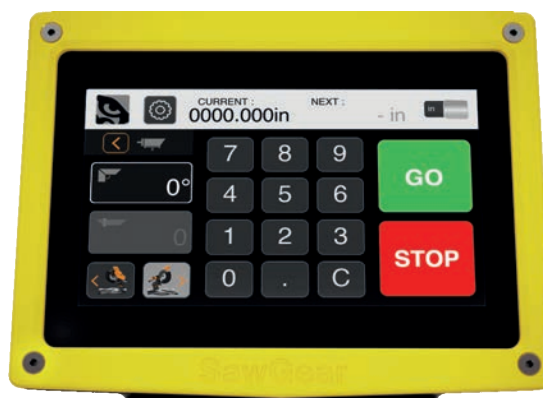
Single Miter Compensation Software: Blijf nauwkeurig bij het verstekken
