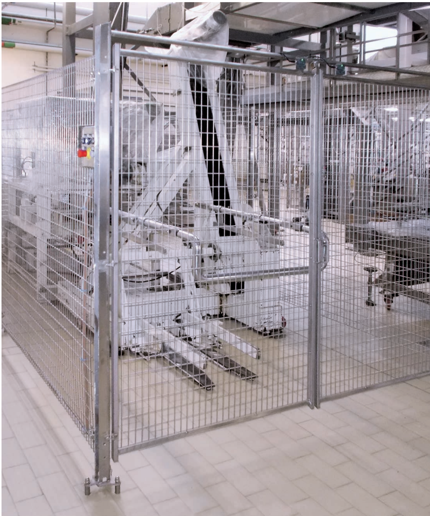
Toepassingsvoorbeeld van het Food Inox-systeem voor het afbakenen van zones met gevaarlijke machines in de voedingsmiddelenindustrie.
