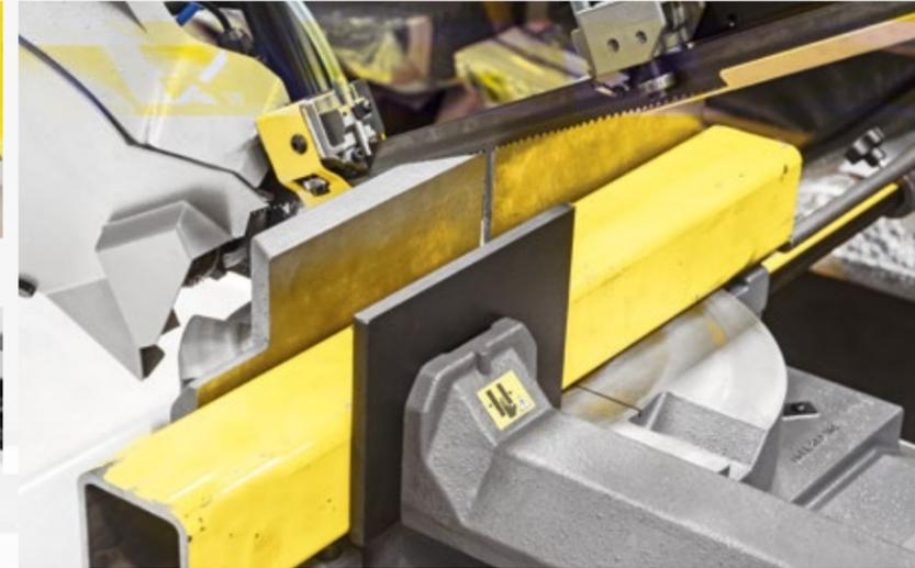
Für Führung des Sägebandes sorgen geschliffene Hartmetalle, welche hohe Schnittgenauigkeit garantieren.
