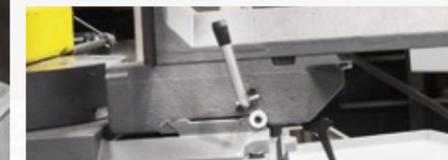
Der Schnellvorschub des Hauptspannstockes ermöglicht, die Spannbacke gemäß der Materialgröße in einigen Sekunden schnell neu einzustellen.
