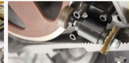
Die Spänebürste ist immer synchron mit der Sägebandgeschwindigkeit angetrieben, so dass ideale Reinigungsleistung garantiert ist.
